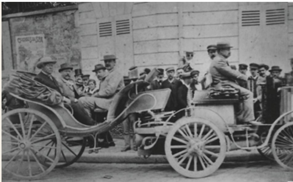
Quatrième «voiture» inscrite, une voiture genre Victoria attelée à un tracteur à vapeur, engagée par De Dion et Bouton qui aligneront ultérieurement aussi une voiture à pétrole. Trépardoux était probablement sur le départ !
